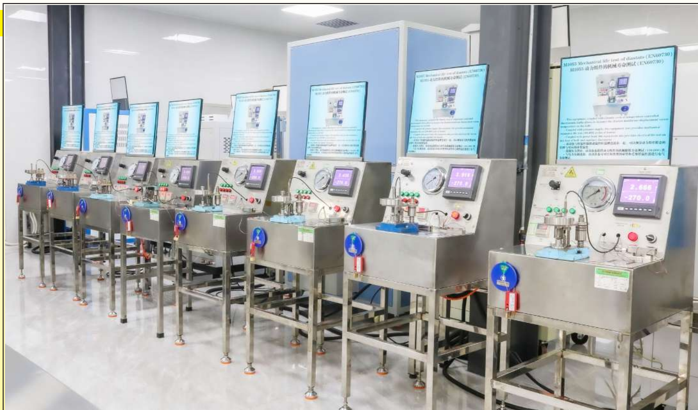
Batterie d'appareils de test de durée de vie de trains thermostatiques. Chaque appareil est équipé d'un enregistreur de paramètres et de nombre de cycles. (Laboratoire Ultimheat).
